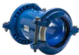
Série 651/00 Manchon symétrique universel Supa One™ pour fonte ductile, acier PVC et PE DN80-200 PN16 Fonte ductile
