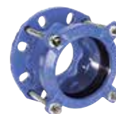
Série 603 Adaptateur à bride Supa® grande tolérance pour PVC, fonte grise, fonte ductile, acier et fibre ciment Perçage universel DN40-400 PN10/16
