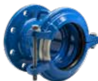
Série 653/00 Adaptateur à bride universel Supa One™ pour fonte ductile, acier, PVC et PE DN80-200 PN16 Fonte ductile
